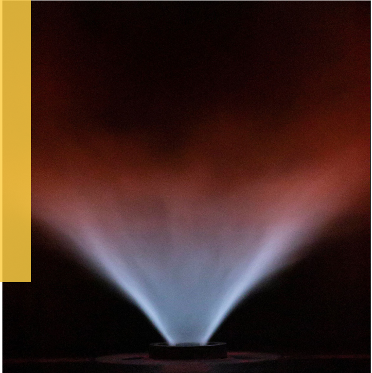
Photographie d'une flamme hydrogène-air stabilisée au-dessus d'un injecteur coaxial à double vrille du laboratoire EM2C-CNRS. © Maxime Leroy and Cecile Oriot - CentraleSupélec
